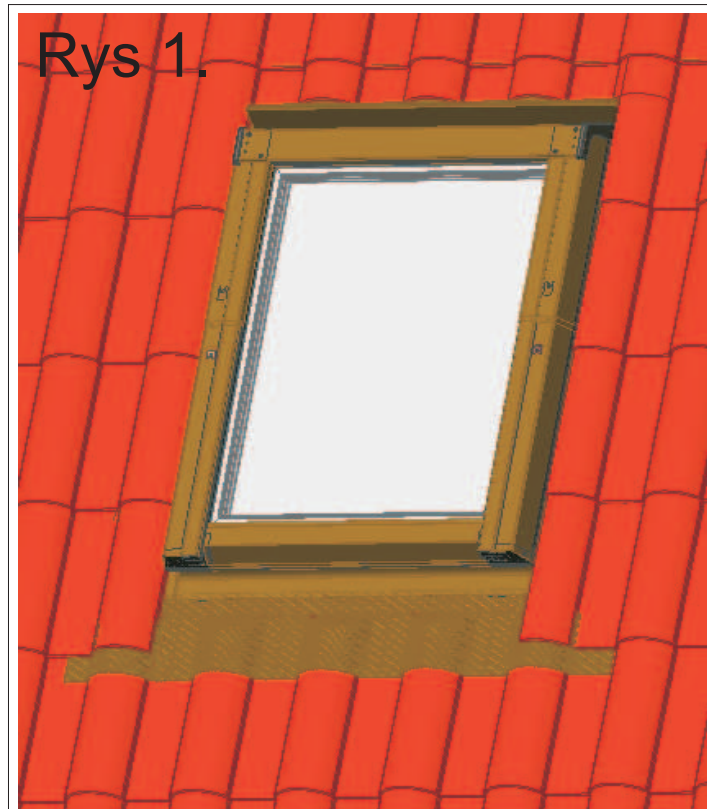
Okno dachowe Skylight Premium zamontowane w dachu.
